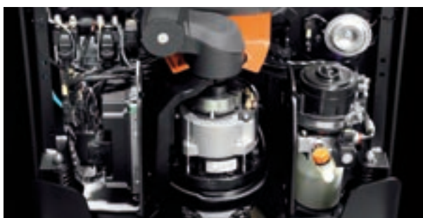
Der fest eingebaute Motor hat keine beweglichen Kabel
