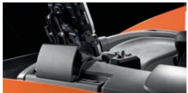
Über die E-Bar-Universalschiene lassen sich Zusatzgeräte wie PCs, Terminals, Barcode-Leser usw. leicht anbauen
