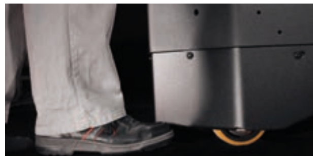
Die niedrige Schürze der P-Serie schützt die Füße des Fahrers, ohne die Arbeit auf Rampen und Gefällen zu beeinträchtigen
