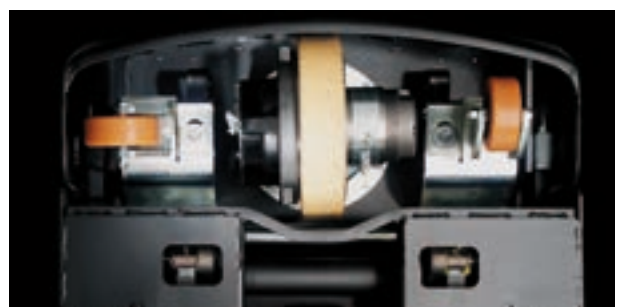
Das 5-Punkt-Chassis des LWE130 gewährleistet optimale Stabilität und Kontrolle – die Stützrollen drehen sich innerhalb des Fahrzeugprofils
