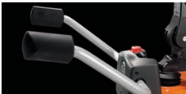
Mit den ausklappbaren Schutzbügeln steigt die Höchstgeschwindigkeit des LPE200 auf 8,5 km/h
